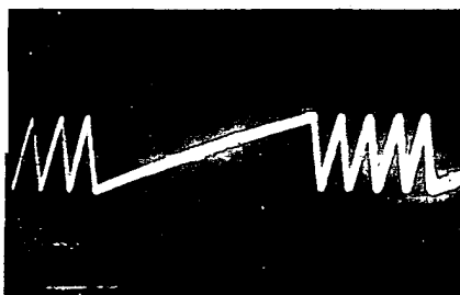
Obr. 11. Průběh napětí na kondenzátoru C8 (C11). Kodér je čtyřkanálový. Měřítka: y = 0,5 \text{ V/cm} , x = 2 \text{ mV/cm}
